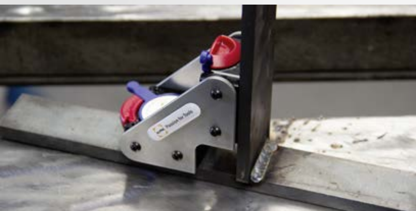
Anwendungs-Beispiel 2: Schweißen von Winkeln
